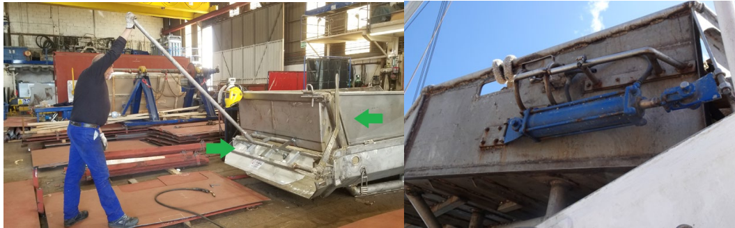
Figura 23 - Mecanismos de puerta de frenado de hopper móvil: manual (Izquierda) e hidráulico (Derecha).
