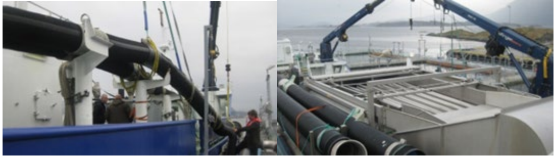
Figura 31 - Mangueras de bomba de vacío y sistemas de clasificación en la cubierta de los barcos para transporte de pescado vivo en Noruega.
