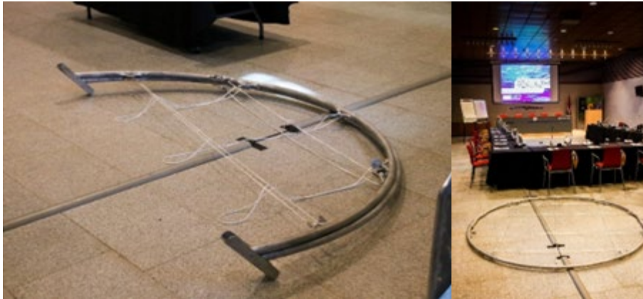
Figura 8 – Parrilla selectiva redonda y ligera con bisagras para plegarse en su formato plegado (izquierda) y extendido (derecha).
