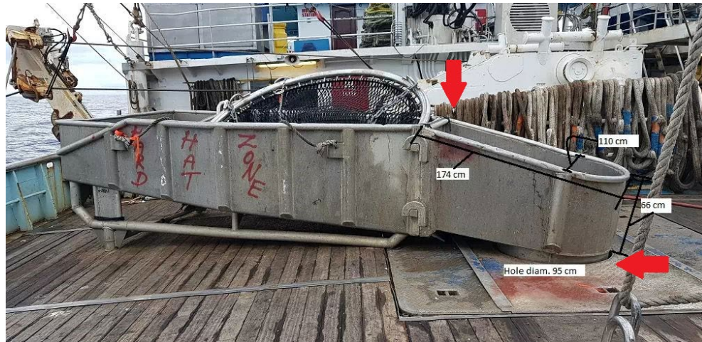
Figura 25 - Diagrama de un hopper con dos puertas de frenado: una ubicada en la parte central del hopper y otra en la base donde entra en la escotilla de descarga.
