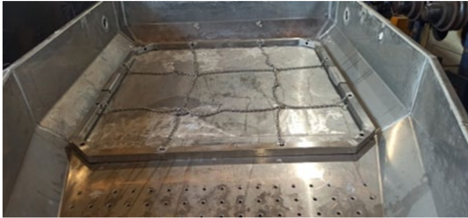
Figura 6 – Parrilla de liberación de mobulas dentro de la bandeja de un hopper.
