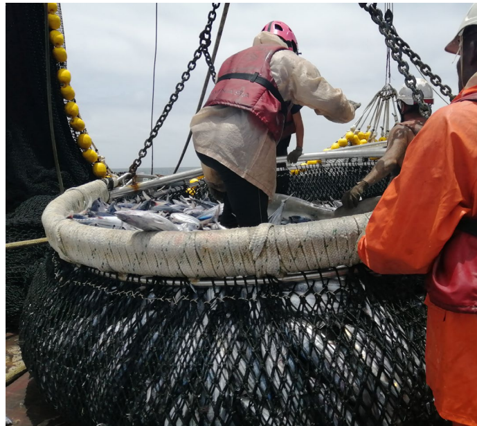
Figura 22 - Salabardo colocado en el costado de la cubierta superior para sacar capturas incidentales en una embarcación sin hopper.
