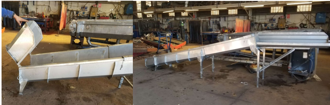
Figura 27 - Rampa con sección final elevable para facilitar el paso (Izquierda) y una sección de "mesa" elevable y patas ajustables para seleccionar la altura adecuada para la liberación de peces accesorias (Derecha).
