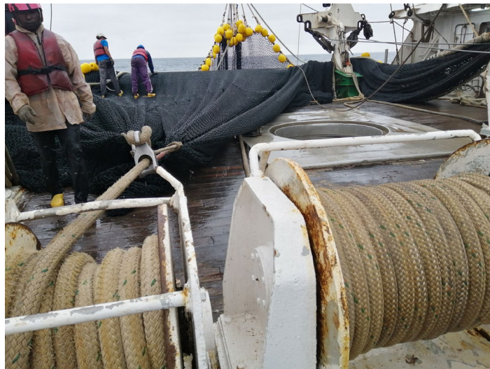
Figura 18 - Vista que muestra los dos chokers y la red que ocupa una gran proporción de la cubierta de trabajo durante la recogida del saco.
