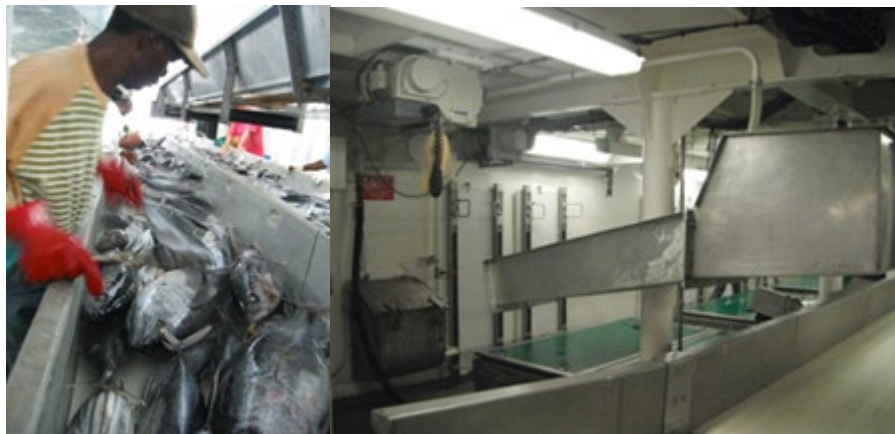
Figura 10 - Doble cinta de liberación de especies accesorias en el parque de pesca (Izquierda) y trancanil cerrado en la pared del parque de pesca (Derecha).
