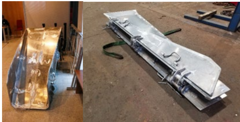
Figura 9 – Rampa de liberación de captura incidental plegable (Izquierda) y rampa plegada para almacenamiento (Derecha).
