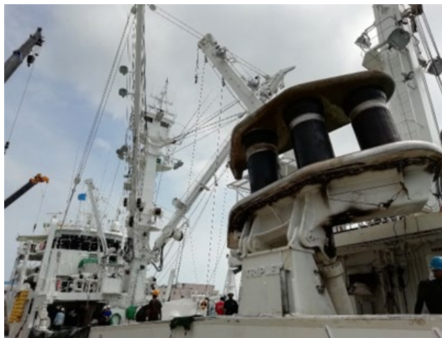
Figura 32 - Sistema Triplex para recoger la red en un pescadero moderno de cerco de atún en el puerto de Yaizu (Japón).
