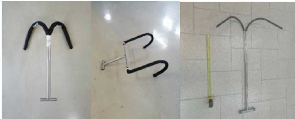
Figura 5 - Diferentes prototipos de manipuladores acolchados para tiburones.
