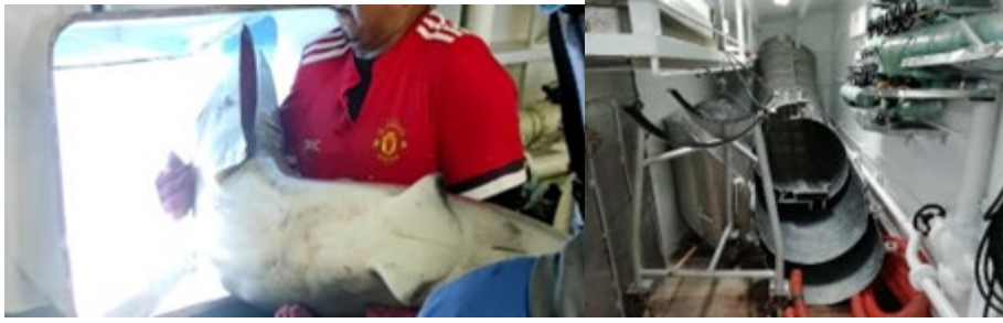
Figura 11 - Pescador transportando a mano tiburón desde la cinta transportadora hasta el trancañil (Izquierda) y sistema móvil de bases con ruedas y secciones de canaletas (Derecha).
