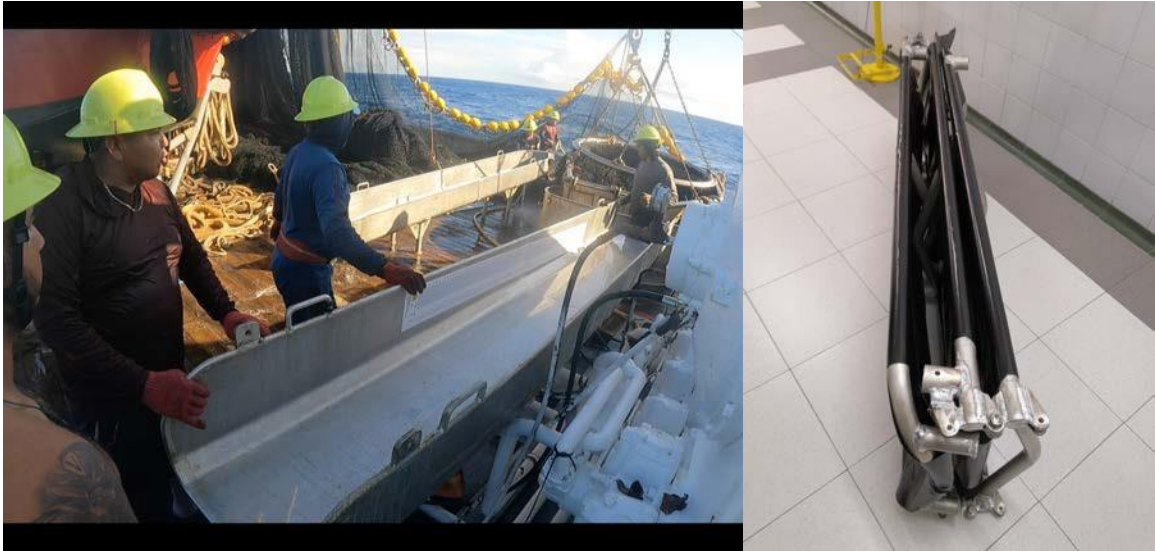
圖 3.可拆卸或摺疊的坡道系統（無論有無卸魚斗），均非永久固定，可於每次下網作業時快速安裝與拆卸。照片：Cape Ferrat 與 ISSF（左），AZTI（右）
