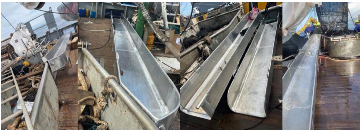
圖 2.與卸魚斗整合的放生坡道系統。照片：Cape Ferrat 與 ISSF
