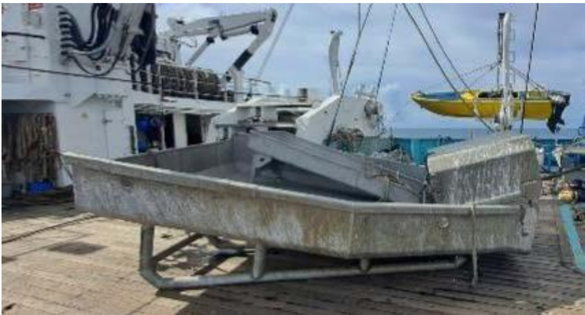
圖 4.存放於卸魚斗承盤內的放生坡道。照片：AZTI
