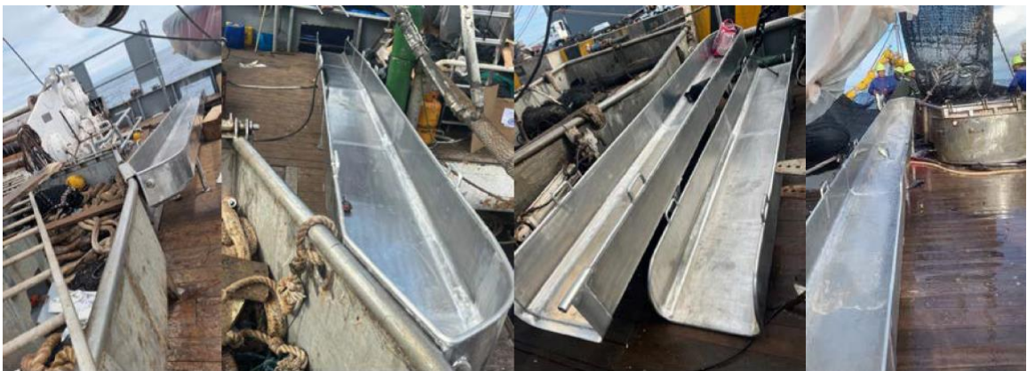
图 2 集成料斗的放归坡道系统。照片：Cape Ferrat 和 ISSF
