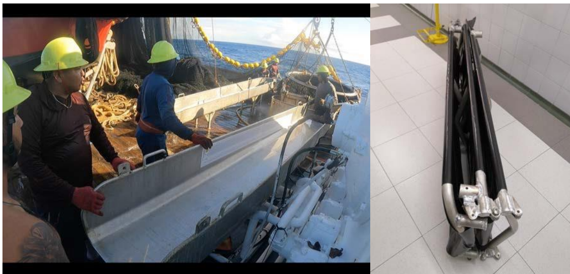
Figure 3. Systèmes de rampes amovibles ou pliables, avec ou sans trémie, non fixés de manière permanente, pouvant être rapidement installés et retirés à chaque opération de pêche. Photos : Cap Ferrat et ISSF (à gauche), AZTI (à droite)
