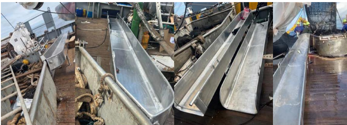
Figure 2. Système de rampe de remise à l'eau intégré à une trémie. Photos : Cap Ferrat et ISSF
