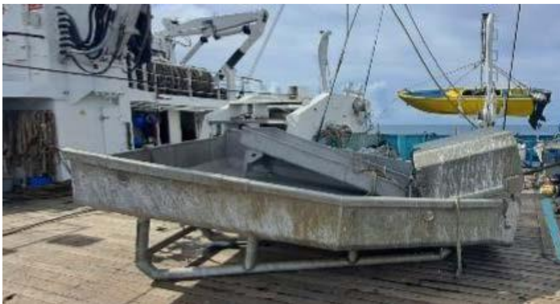
図4：ホッパートレイ内に保管されたリリース用傾斜台。写真：AZTI
