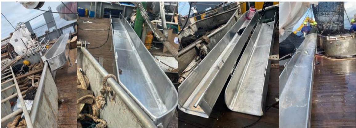
図2：ホッパー組み込み型のリリース用傾斜台システム。写真：Cape Ferrat および ISSF
