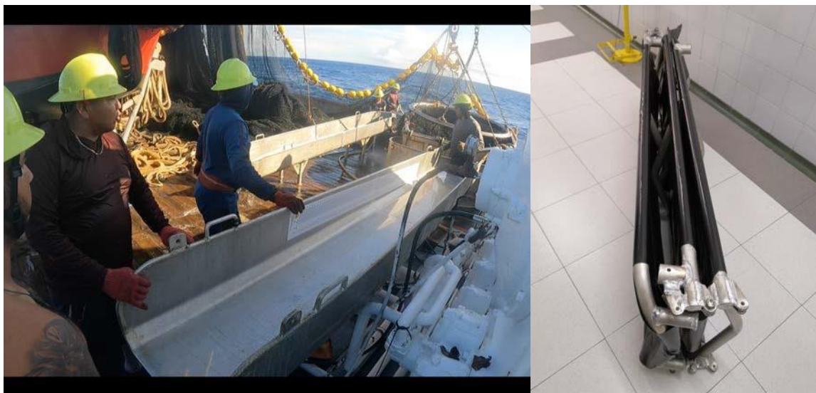
図3：取り外せる傾斜台システム／折り畳める傾斜台システム（ホッパーあり、なし）。傾斜台システムは恒久的にホッパーに取り付けられているものではなく、毎回操業中に速やかに取り付け、取り外しできます。写真：Cape Ferrat&ISSF（左）、AZTI（右）
