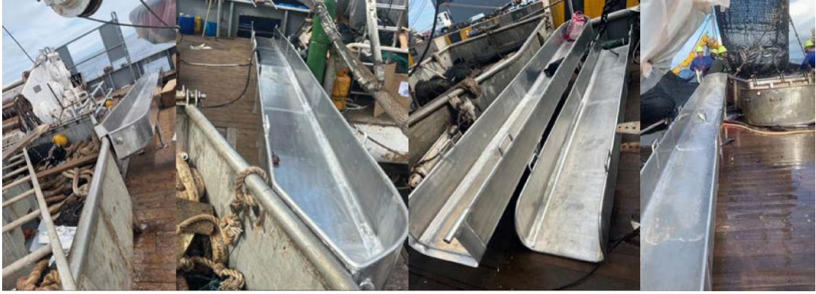
그림 2. 호퍼가 통합된 방류 경사로 시스템. 사진: Cape Ferrat 및 ISSF
