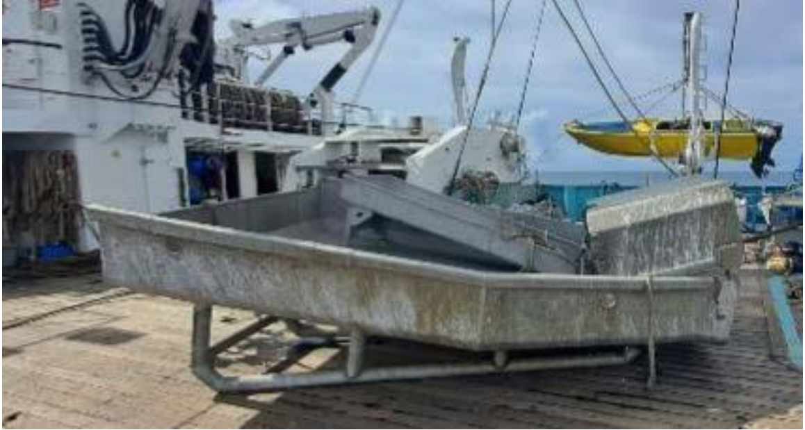
그림 4. 호퍼 트레이 안에 보관된 방류 경사로. 사진: AZTI
