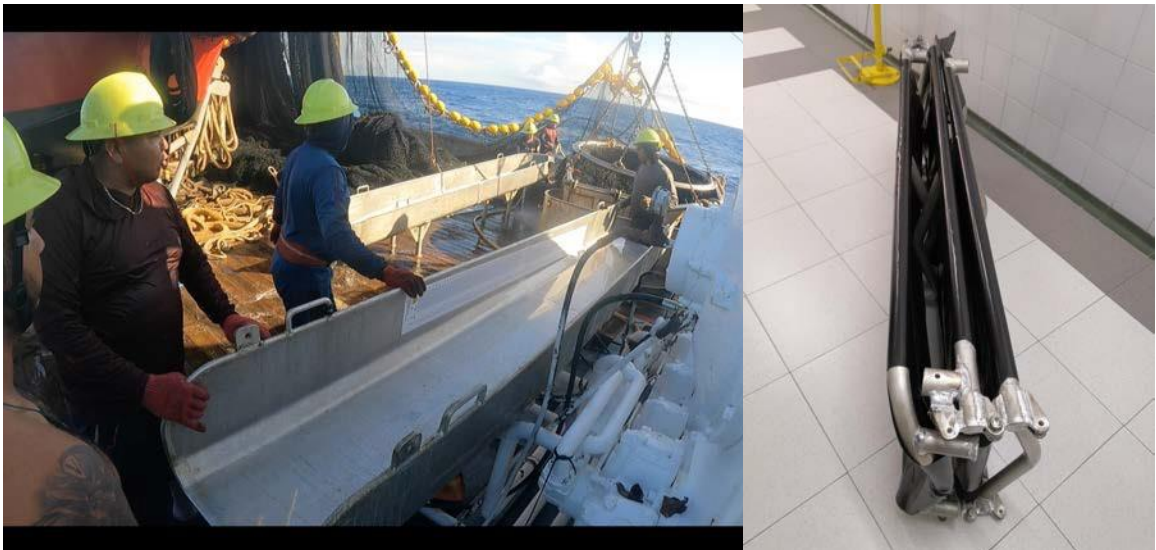
그림 3. 호퍼가 있든 없든 분리식 또는 접이식 경사로 시스템은 영구적으로 고정되지 않아서 각 조업마다 신속하게 설치하고 제거할 수 있습니다. 사진: Cape Ferrat 및 ISSF (왼쪽), AZTI(오른쪽)
