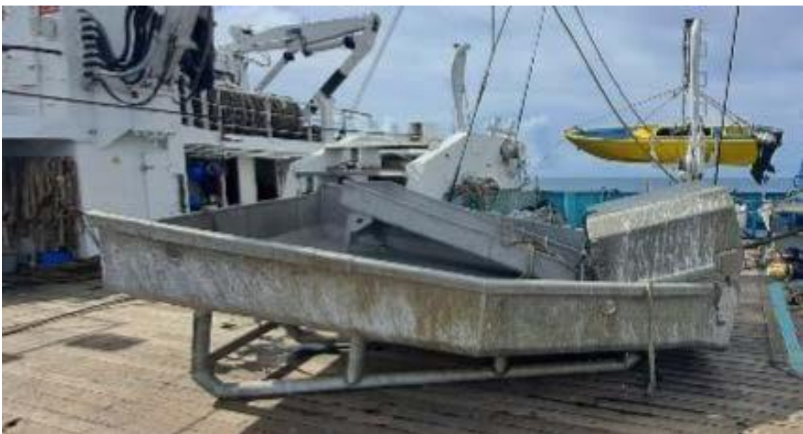
Figura 4. Rampa de liberación almacenada en el interior de la bandeja de la tolva. Foto: AZTI
