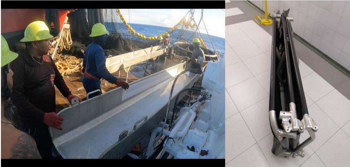
Figura 3. Sistemas de rampa separables o plegables, con o sin tolva, no instaladas permanentemente, que se pueden instalar y quitar rápidamente durante cada lance de pesca. Fotos: Cape Ferrat e ISSF (izquierda), AZTI (derecha)
