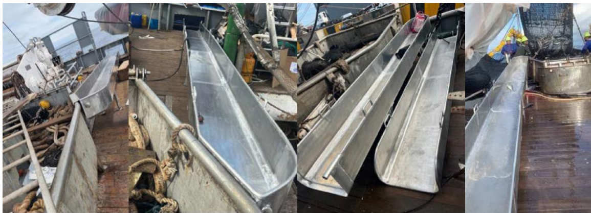
Figura 2. Un sistema de rampa de liberación integrada a una tolva. Fotos: Cape Ferrat e ISSF
