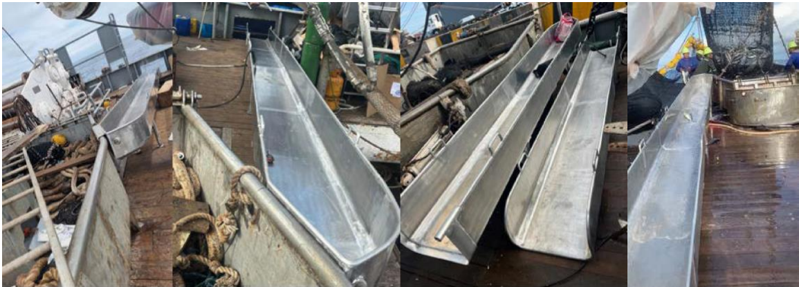
Larawan 2. Isang sistemang rampa ng pagpapakawala na isinama sa hopper. Mga Litrato: Cape Ferrat at ISSF
