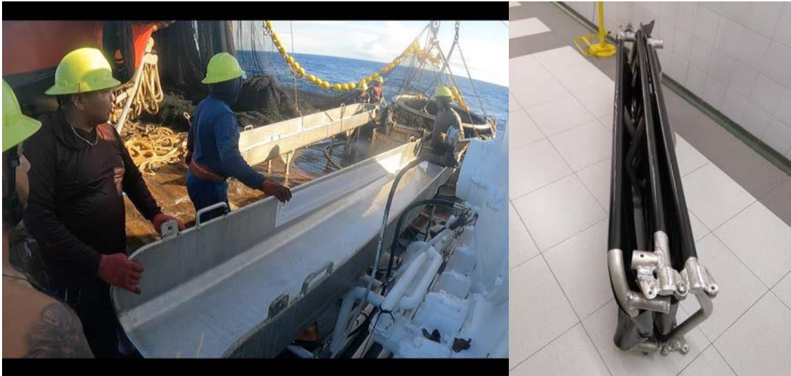
Larawan 3. Mga sistemang rampa na natatanggal o natitiklop, may hopper man o wala, na hindi permanenteng nakakabit at maaaring mabilis na ikabit at tanggalin sa bawat set ng pangingsda. Mga Litrato: Cape Ferrat at ISSF (kaliwa), AZTI (kanan)
