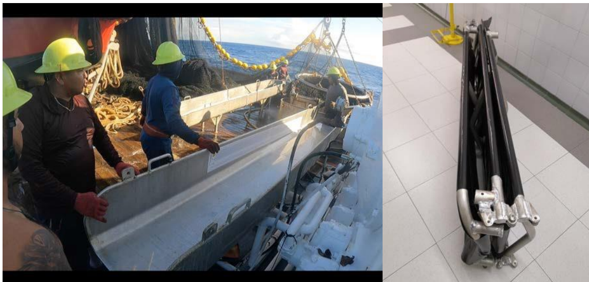
Hình 3. Hệ thống đường trượt có thể tháo rời hoặc gấp gọn, có hoặc không có phễu, không cố định vĩnh viễn, có thể lắp đặt và tháo dỡ nhanh chóng trong mỗi mẻ đánh bắt. Ảnh: Cape Ferrat và ISSF (bên trái), AZTI (bên phải)
