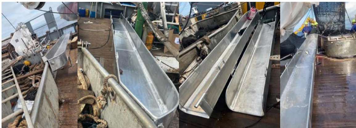
Hình 2. Hệ thống đường trượt thả cá mập tích hợp với phễu. Ảnh: Cape Ferrat và ISSF
