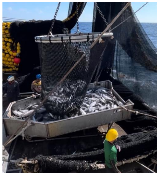
图3 有些渔船使用料斗卸载渔获物，并在鱼类通过卸载舱口进入鱼舱前进行初步分选。使用料斗有助于在上层甲板对非目标物种进行放归操作。蝠鲼分选网格与料斗兼容。照片：Melissa Cronin, Pacific Princess
