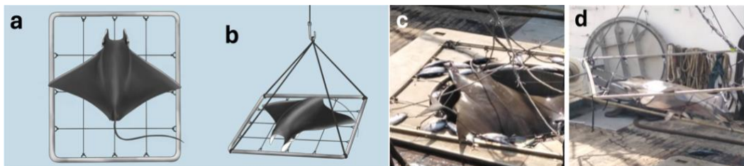
图 1(a) 蝠鲼分选网格可快速放归前口蝠鲼和魔鬼（蝠鲼科）鱼。蝠鲼分选网格应：(b) 让蝠鲼平躺，(c) 使目标鱼类能够通过网格格栅，(d) 能够连接四根绳索，用起重机起吊。示意图：Life Science Studio；照片：AZTI
