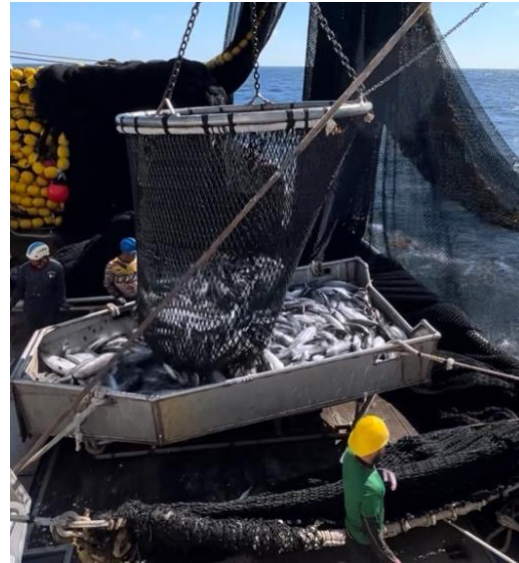
Figure 3. Certains navires utilisent une trémie pour décharger les prises et effectuer un tri préliminaire avant que les poissons ne passent par la trappe de déchargement pour rejoindre les cales à poissons. La trémie permet de mieux remettre à l'eau les espèces non ciblées depuis le pont supérieur. Les grilles de tri des raies sont compatibles avec les trémies. Photo : Melissa Cronin, Pacific Princess
