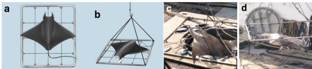
Figure 1. (a) La grille de tri des raies permet de rapidement remettre les raies à l'eau. La grille de tri doit : (b) permettre à la raie d'être à plat; (c) permettre aux poissons ciblés de passer à travers les mailles; (d) avoir quatre cordes pour un levage à l'aide d'une grue. Illustration : Life Science Studios; Photos: AZTI
