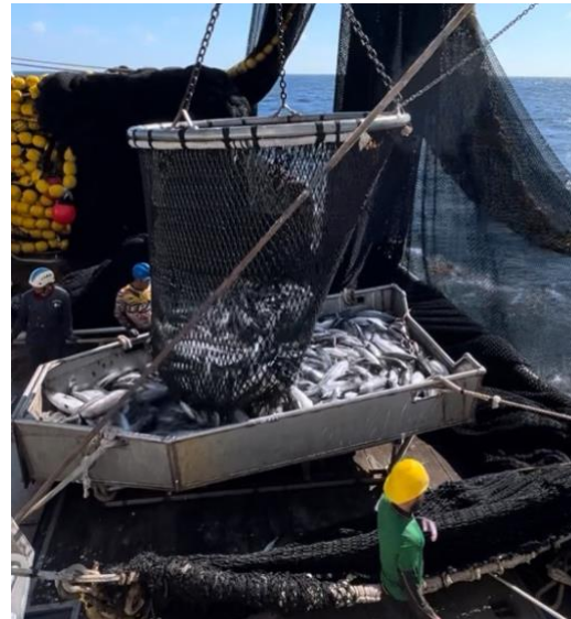
Gambar 3. Sebagian kapal menggunakan hopper untuk menumpahkan hasil tangkapan dan melakukan penyortiran awal sebelum ikan dimasukkan ke palka penyimpanan ( fish well ) melalui pintu palka bongkar muat. Penggunaan hopper mempermudah proses pelepasan spesies nontarget dari geladak atas. Kisi-kisi penyortiran pari manta dapat digunakan bersama hopper . Foto: Melissa Cronin, Pacific Princess
