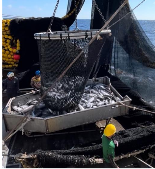
그림 3. 일부 선박은 호퍼를 사용하여 어획물을 방출하고 하역 해치를 통해 어창으로 들어가기 전 1차 분류를 진행합니다. 호퍼를 사용하여 상갑판에서 비표적 어종 방류를 더욱 원활하게 할 수 있습니다. 쥐가오리류 분류 격자는 호퍼와 함께 사용할 수 있습니다. 사진: Melissa Cronin, Pacific Princess
