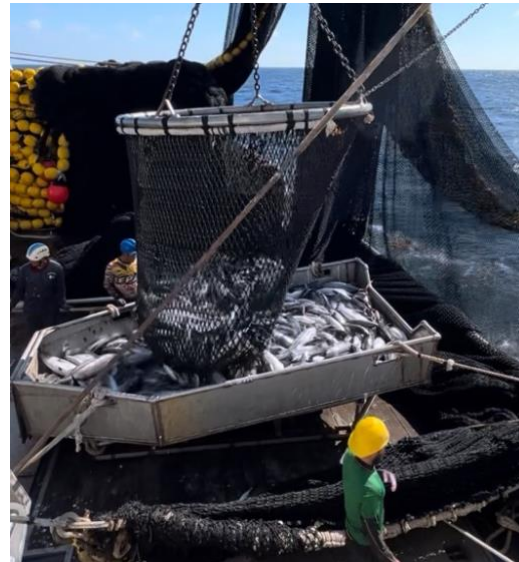
Figura 3. Algunos buques tienen una tolva para descargar la captura y realizar la selección preliminar antes de que el pez pase a través de la escotilla de descarga a los pozos de pescado. El uso de una tolva facilita una mejor liberación de especies no objetivo desde la cubierta superior. Las rejillas de selección de mantarrayas son compatibles con las tolvas. Foto: Melissa Cronin, Pacific Princess
