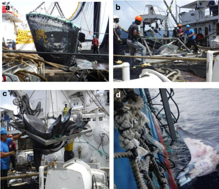
Figura 5. Pasos principales del uso de la rejilla de selección de mantararrayas. Fotos: AZTI
