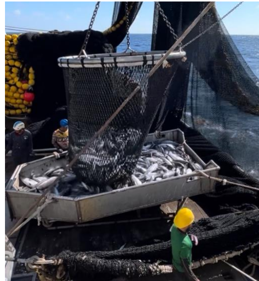
Larawan 3. Ang ilang sasakyang-dagat ay gumagamit ng hopper upang ibuhos ang huli at magsagawa ng paunang pag-uuri bago dumaan ang isda sa unloading hatch papunta sa mga fish well. Ang paggamit ng hopper ay nagpapahusay sa pagpapakawala ng mga hindi target na species mula sa itaas na deck. Ang manta sorting grids ay compatible sa mga hopper. Larawan: Melissa Cronin, Pacific Princess
