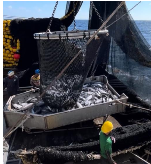
Hình 3. Một số tàu sử dụng phễu để đổ mẻ đánh bắt và thực hiện phân loại sơ bộ trước khi cá lọt qua cửa xả vào các hầm cá. Việc sử dụng phễu giúp cải thiện hiệu quả thả các loài không phải mục tiêu từ boong trên. Lưới phân loại cá đuối manta tương thích với phễu. Ảnh: Melissa Cronin, Pacific Princess
